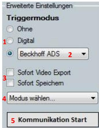
1. Aktivieren des Triggermodus mit Auswahl der Signalquelle
