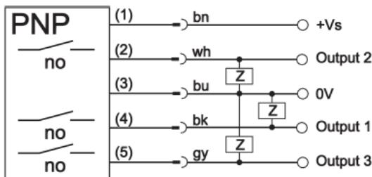
Steckerbelegung (bei Blick auf das Gerät):
