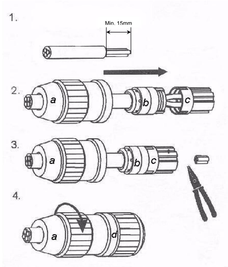
Kabelmantel so absetzen, dass die einzelnen Adern mindestens 15mm heraussehen.
