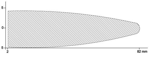
sichere Erkennung eines Objektes von 15x15mm
