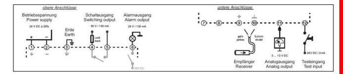
Für eine EMV-gerechte Installation muss die Funktionserde Klemme 3 auf kurzem Wege mit der Schaltschrank oder Maschinenerde verbunden werden.
